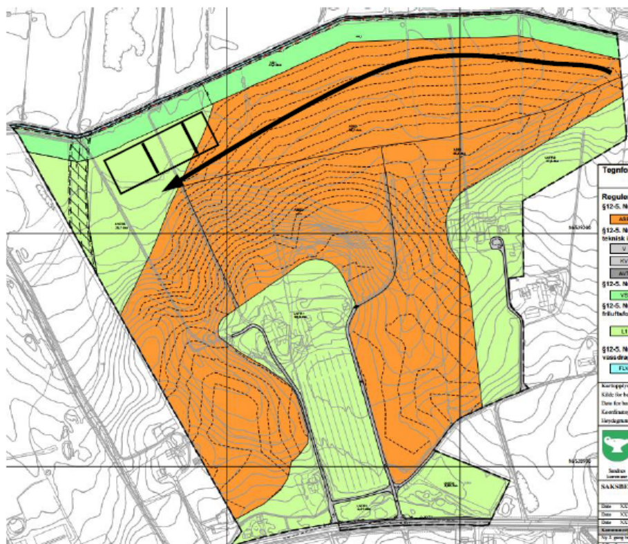
Figur 3 VA-rammeplan: Skisse for avrenningsgrøfter og sedimenteringsbasseng
